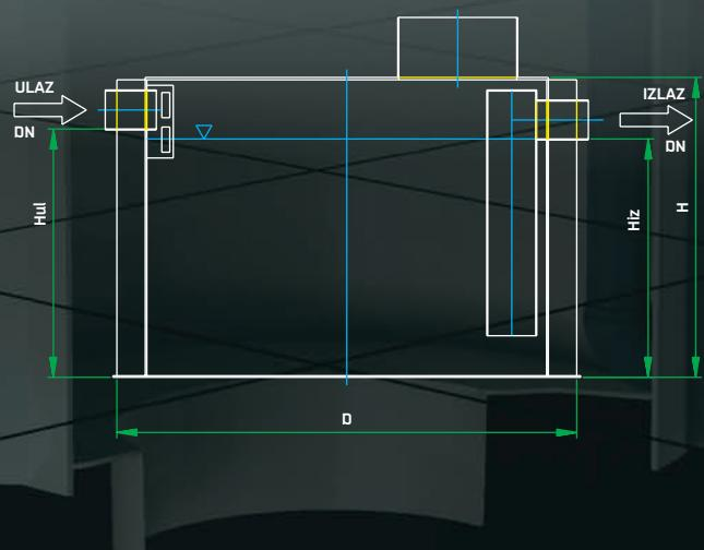
Upotrebljavaju se za prečišćavanje otpadnih voda s parkirališta, benzinskih pumpi, itd., odnosno u slučajevima kada je prisutno zagađivanje atmosferske ili procesne vode uljnim tečnostima, a recipijent je kolektor-kanalizacija. Rade na principu razlike specifičnih težina tečnosti.
