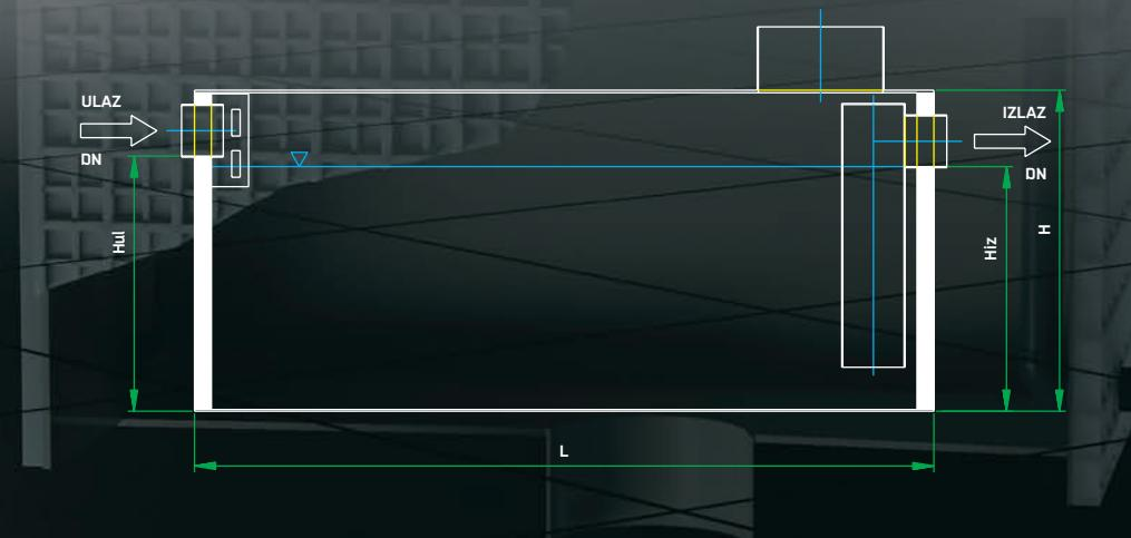
Upotrebljavaju se za prečišćavanje otpadnih voda s parkirališta, benzinskih pumpi, itd., odnosno u slučajevima kada je prisutno zagađivanje atmosferske ili procesne vode uljnim tečnostima, a recipijent je kolektor-kanalizacija. Rade na principu razlike specifičnih težina tečnosti.
