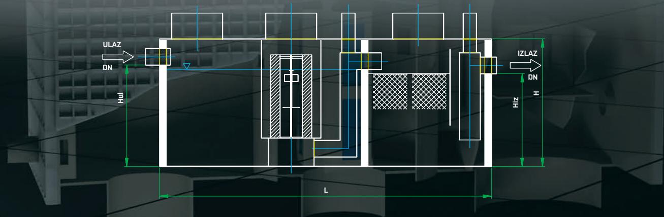
Separatori ulja BP OLEX L/KF/SF namenjeni su za vodoopskrbna područja sa srednjom količinom mulja. Služe za prečišćavanje atmosferske ili procesne vode zagađene zauljenim tečnostima. Nakon prečišćavanja voda se može ispušтati u prirodni recipijent.
