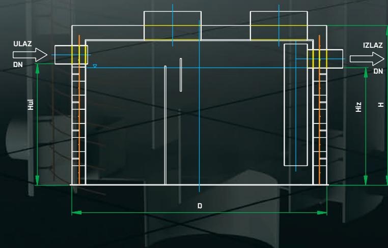
Separatori masti služe za prikupljanje organskih ulja i masti koje sadrži otpadna voda iz kuhinja, prehrabne industrije, klanica, itd. Odvajanjem masti sprečava se začepljenje sistema kanalizacije i zagađenje vodotoka.
