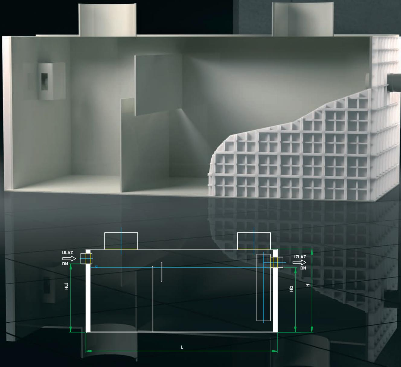
Separatori masti služe za prikupljanje organskih ulja i masti koje sadrži otpadna voda iz kuhinja, prehrane, industrije, klanica, itd. Odvajanjem masti sprečava se začepljenje sistema kanalizacije i zagađenje vodotoka.
